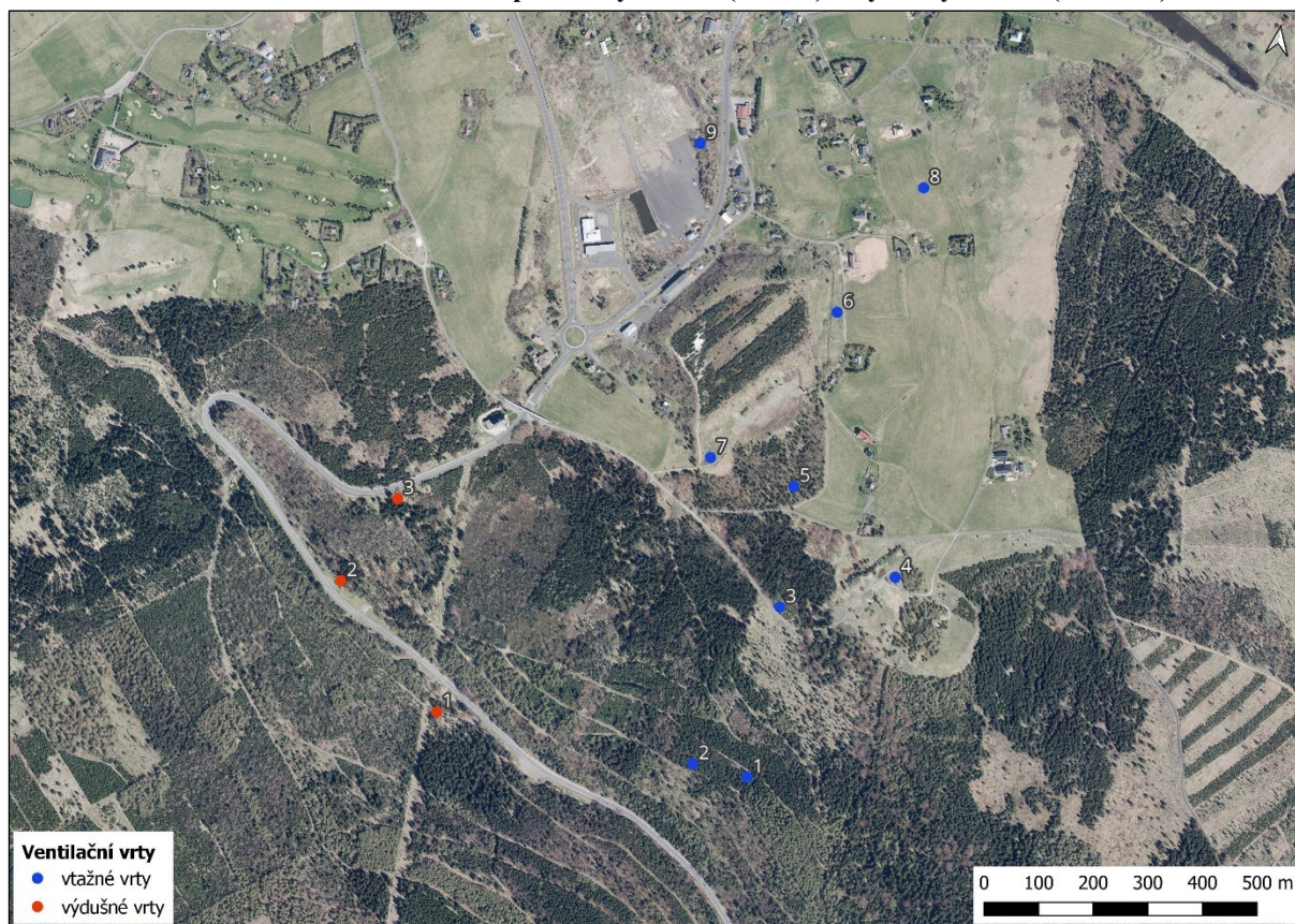
Obrázek č. 49: Horní závod – situační mapa vtažných vrtů (Intake) a výdušných vrtů (Exhaust)
