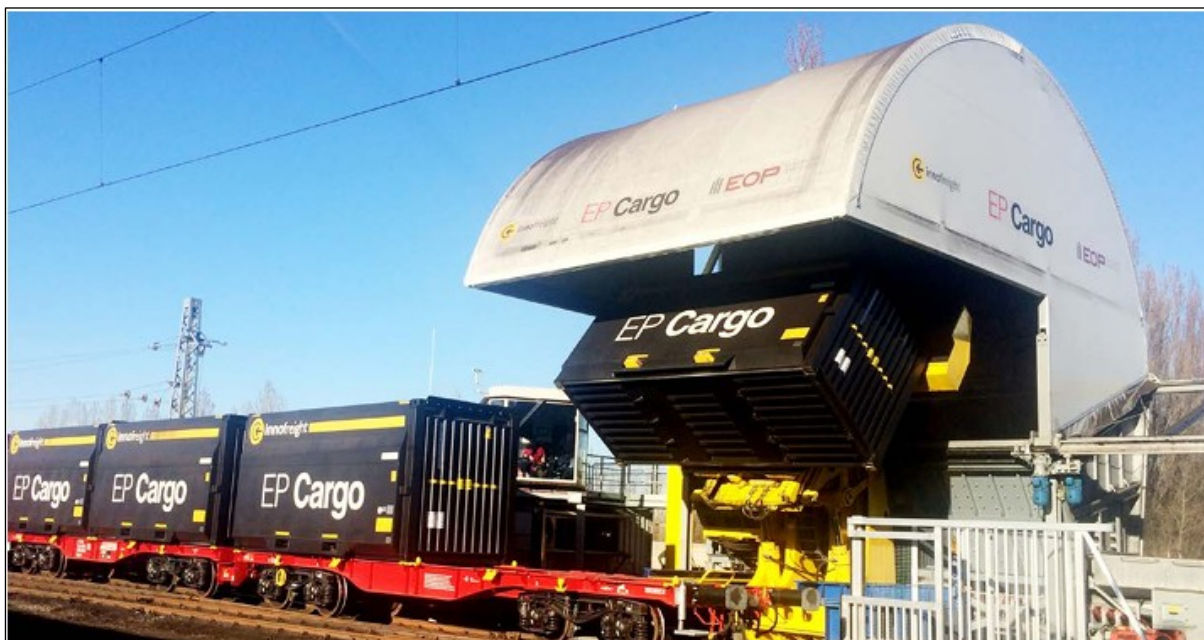
Obrázek č. 105: Překladiště – robotický železniční vykládací systém
