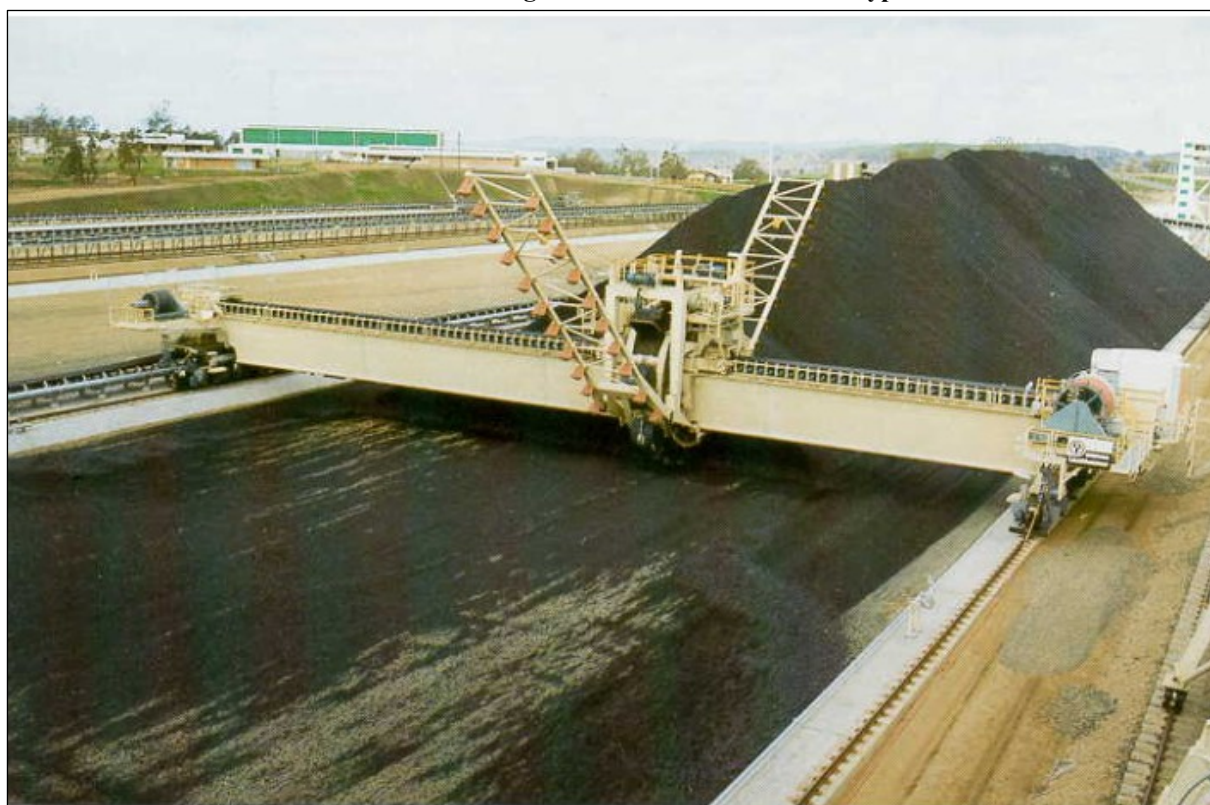
Obrázek č. 102: Překladiště – ilustrativní fotografie mostového kolesového rypadla
