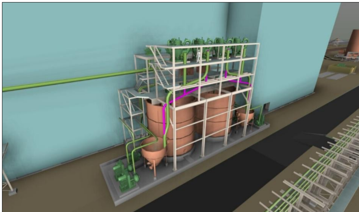
Obrázek č. 122: Zpracovatelský závod – FECAB vizualizace zařízení k odstranění kalu
