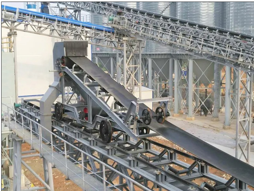
Obrázek č. 101: Překladiště – vizualizace pojízdného shazovacího vozu v budově kryté skládky rudy (DB)
