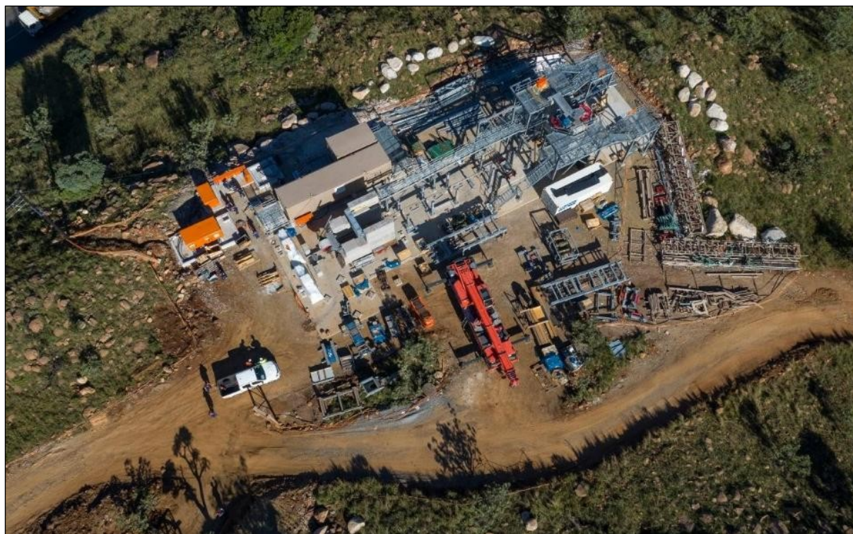
Obrázek č. 73: RopeCon – montážní fáze stanice (jihoafrické instalace RopeCon; Doppelmayr, 2023)
