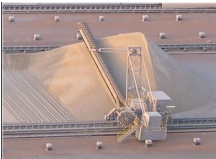
Obrázek č. 127: Zpracovatelský závod – FECAB ilustrativní obrázek bočního škrabákového stroje
