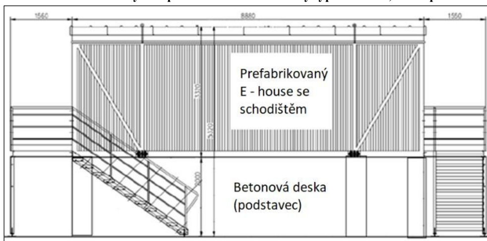
Obrázek č. 183: Výkres prefabrikované rozvodny typu E-house, čelní pohled
